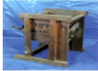
66 いちき 芋切り サツマ芋を薄く切り、 乾燥させて保存した
