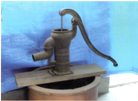
55 てお 手押しポンプ 井戸水を汲み上げる
